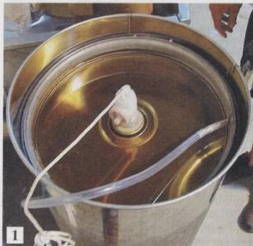
1-Quando aumenta la temperatura il vino può uscire dallo sfiato del coperchio galleggiante ad aria e può inacidire inquinando anche il vino presente nel contenitore. 2-Coperchio galleggiante di un semprepieno con incrostazioni causate dall'evaporazione del vino tracimato: è necessario di pulirlo seguendo le indicazioni a pag. 84
