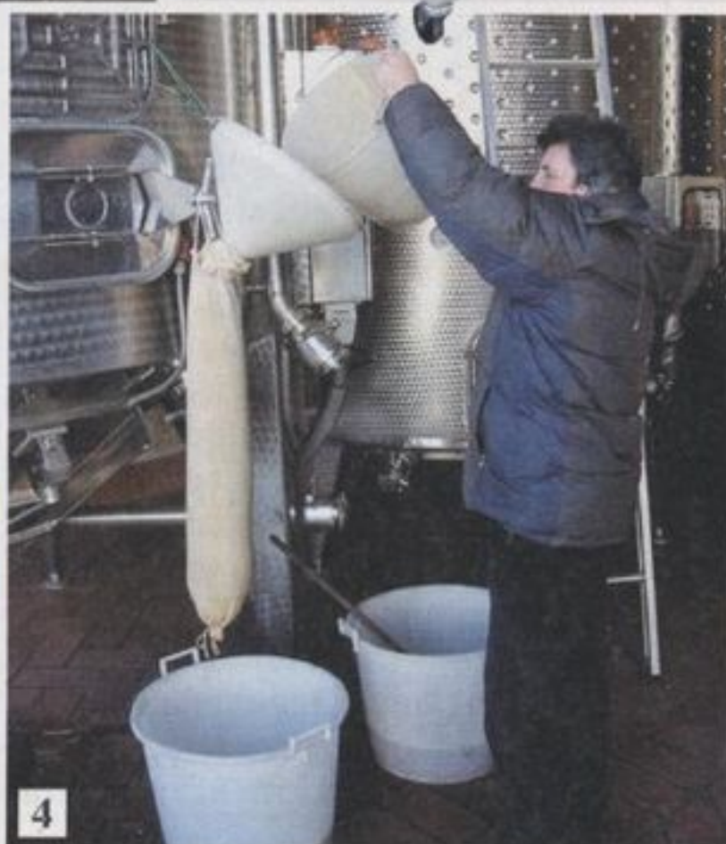
1-Filtro ad alluvionaggio continuo per la filtrazione con farina fossile. 2-Filtro a farina fossile a sacco per piccole aziende. All'interno della campana, come supporto al prepannello e alla farina fossile viene posto un sacco filtrante in tessuto poliestere. 3-Filtro a sacco «olandese»: a sinistra la rete di contenimento, a destra il sacco piegheggiato. 4-Riempimento del filtro «olandese»
