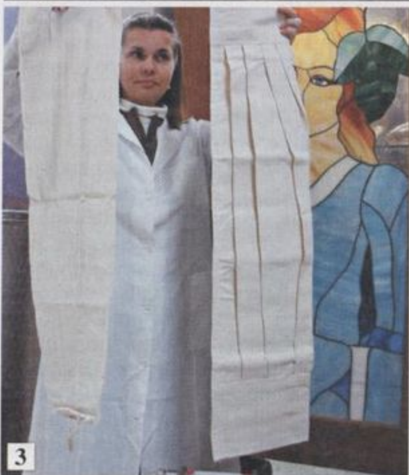
1-Filtro ad alluvionaggio continuo per la filtrazione con farina fossile. 2-Filtro a farina fossile a sacco per piccole aziende. All'interno della campana, come supporto al prepannello e alla farina fossile viene posto un sacco filtrante in tessuto poliestere. 3-Filtro a sacco «olandese»: a sinistra la rete di contenimento, a destra il sacco piegheggiato. 4-Riempimento del filtro «olandese»
